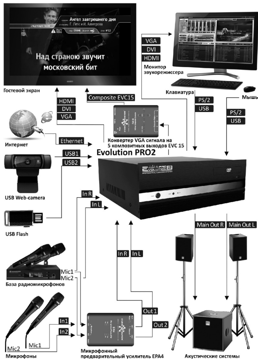
Рис. 3: Схема подключения караоке-системы «Evolution PRO2». Вариант №1
